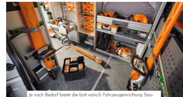
Je nach Bedarf bietet die bott vario3- Fahrzeugeinrichtung Stauraum für Handwerkzeuge und Verbrauchsmaterialien und verfügt über Zurrleisten zur Befestigung weiterer Transportgüter.
